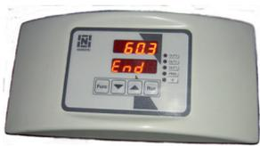
Il controllo della temperatura e del ciclo di cottura è affidato ad un programmatore a microprocessore mod. K1PX, con il quale è possibile memorizzare 4 cicli di cottura,
