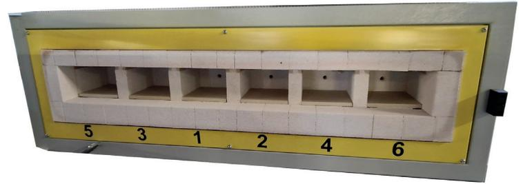
La caratteristica di un forno a gradiente è di avere diverse zone di cottura con temperature differenziate (gradiente termico), che seguono lo stesso ciclo di cottura, su campioni dello stesso tipo. Il Mod. 95/S è costituito da n°6 celle riscaldanti indipendenti.<sup>1</sup>
